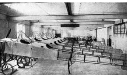
Qui sopra, la prima linea per il montaggio in serie allestita dalla S.I.T. e, in alto, la pubblicità dell'Azienda con Manissero come "testimonial".
